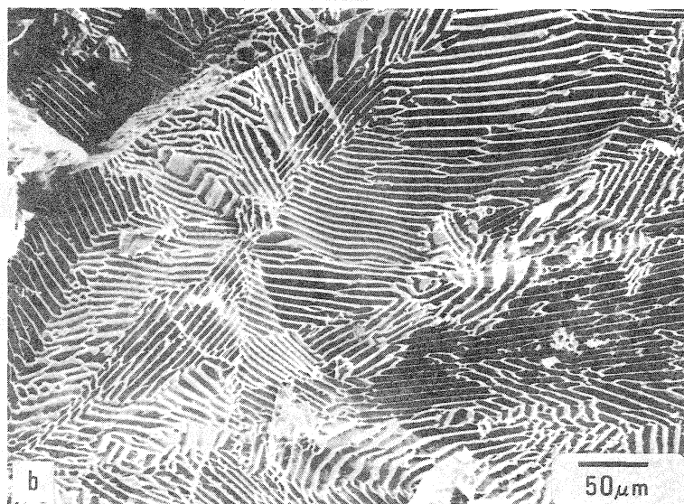
図5: ベーマイトゾル(a)及びゲル(b)の凍結によるパターン形成(6wt%)
