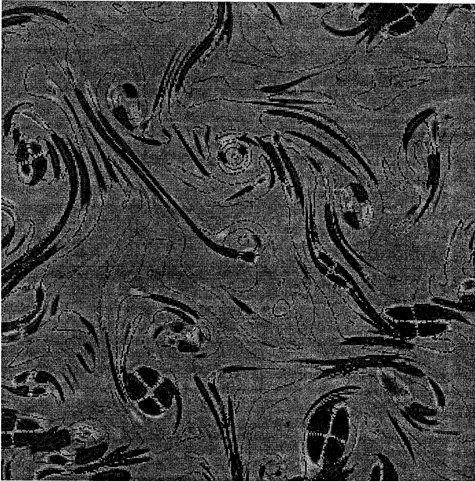
図 3: ランダムな初期条件の元で擬スペクトル法を用いて得られた渦度場。濃淡はパリンストロフィ生成の大きさに対応。
