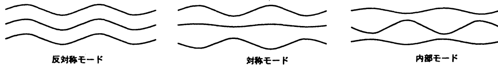
図 4: 2層液体シートでの固有モード
