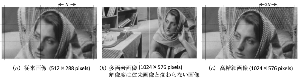
図1 従来画像の N \times N 領域の表現に高精細画像ではより多く 2N \times 2N の標本値が必要
