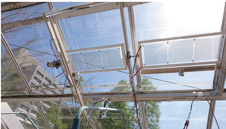
写真4：実験用ハウスに装着した太陽光パネル（2017年7月27日に李治が撮影）
