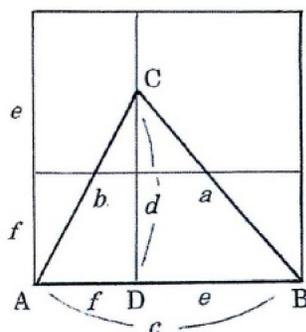
私たちは結果を知っているから、各長さを恰も既知であるかのように考える（上図はその立場に立つ）。しかし、厳密には、既知な長さは三辺の長さ  $a, b, c$  のみであり、他の長さは 未知 である。これら未知の長さの追求が核心である。垂足  $D$  が求まれば、下辺  $c$  は  $f$  と  $e$  に分けられ、股の右側  $DB = e$  も求まり、一件落着する。（西洋流の方法で、コンパスのみを用いた垂足  $D$  の作図は可能だが、課題は、計算的に その位置を求める事を要求している。）しばらく、垂線の高さ  $CD = d$  を補助変数  $y$  とし、右股  $DB = e$  を未知数  $x$  としよう。
