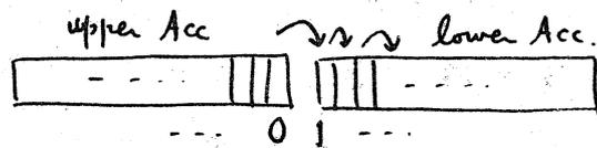
浮動小数点数を表わして 113 が、lower Acc. の最上位ビットが 1、その上が 0 のとき、最後に剰余の正規化をしてシフトすると、lower Acc. の最上部が 01 になるべきなのだが、とまたま 11 となる誤動作であることが確認された。
