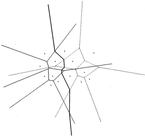
図4: 左半分の点のポロノイ図 (実線), 右半分の点のポロノイ図 (破線) とそれらをつなぐ折れ線 (太線)
