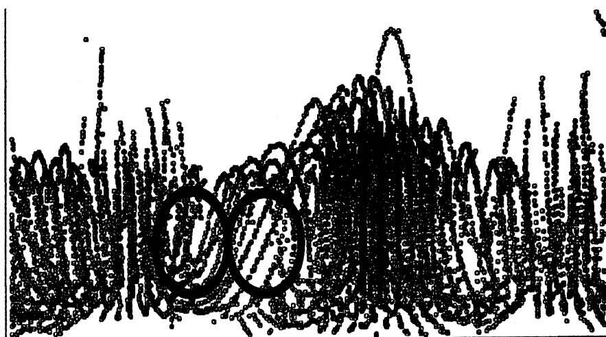
Fig 7: 容器に相対的な粒子の軌跡 ( f/2 -ripple).
