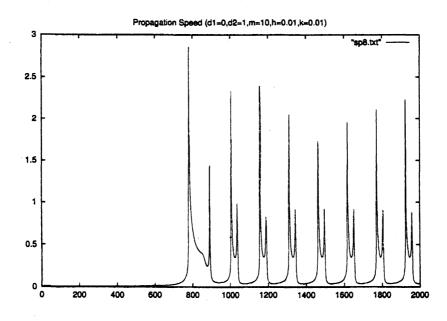
図  $6:\ 0 \leq t \leq 2000$  にたいするフロント速度  $\dfrac{dx}{dt}(t)$   $(d_1=0,d_2=1,m=10)$  のグラフ
