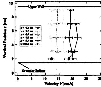
図 2.3b 鉛直方向流速分布
