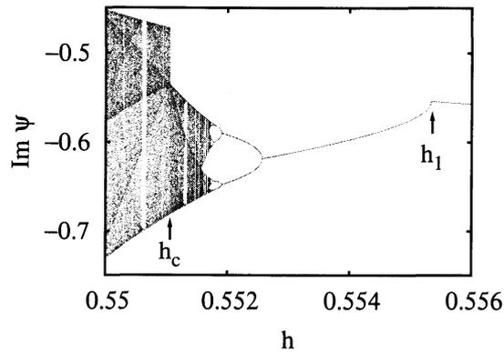
図 1: 分岐図。横軸はコントロールパラメータ  $h$ 。縦軸はポアンカレ断面  $\text{Re } \psi = 0$  かつ  $\text{Re } \psi > 0$  での  $\text{Im } \psi$ 。
