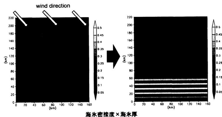
図4 氷縁が存在するときのアイスバンドパターン。風は氷縁に対して左  $45^\circ$  の向きに吹いている (左図矢印)。
