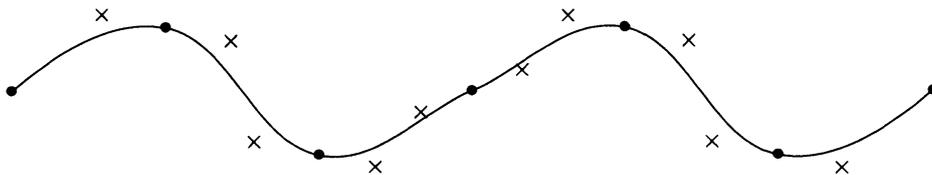
上の [8] では  $y = \sin x$  ( $0 \leq x \leq 4\pi$ ) のグラフを  $x$  の値で 48 等分した曲線上の点を繋いで曲線を描いている。[10] では、6 等分に減らした曲線上の点  $\bullet$  と、その 7 点を元に定めた制御点  $\times$  と、それらを元に描いた曲線を示した。
