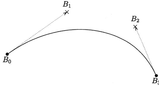
この3次の Bézier 曲線は、始点  $B_0$  から  $\overrightarrow{B_0B_1}$  に接する方向に出て、 $B_3$  には  $\overrightarrow{B_2B_3}$  に接する方向に入る。
