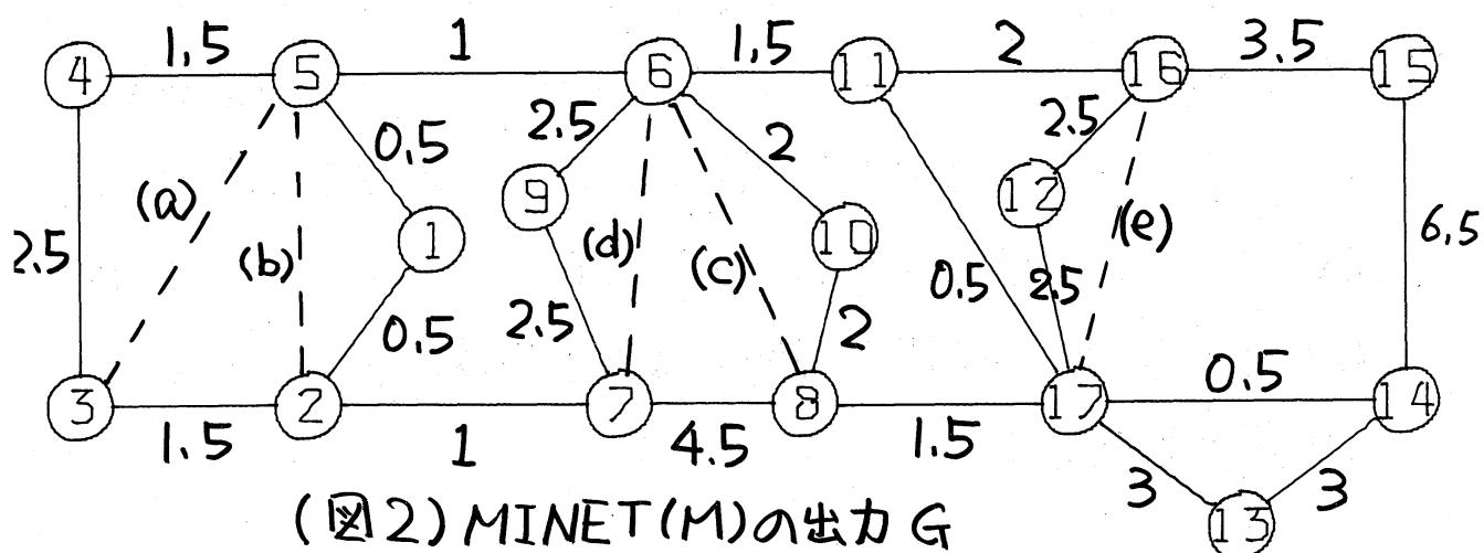
要素 $\alpha$  和 分解式が(a)~(e)である。ハセ图に付加してある $\Rightarrow$ 以外の矢印は、各和分解式で用いた要素を表している。(図2)はMINET(M)の出力Gである。点線の枝は、各和分解式による容量が零となり消滅した枝を示す。(定理2)より枝数は( $n=17, P=4, Q=5$ であるから) 23である。(在来の構成法との比較)を記したようにMINET(M)は在来の構成法より真に少ない枝数で実現するが、これは次の理由による。
