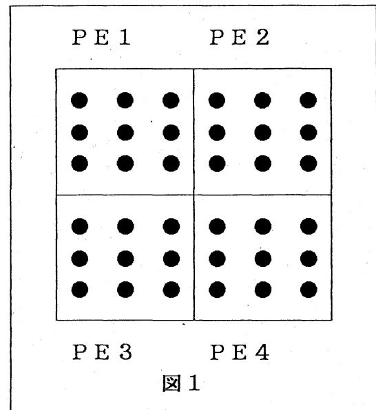
算を進めている超並列計算機、富士通AP1000の要素は2次元配列なので、<sup>(+)</sup> 4次元空間を2次元面の上で分割しなければならない。一番簡単なのはxとyの部分を分割することである(図3)。尤もらしく「x yパーティション」となずける。このときゲージ系の特徴のため、前後左右だけでなく、斜め方向のPE間の通信も必要になる。<sup>(\*)</sup> 現在の世界のトップレベルのスケールの問題
