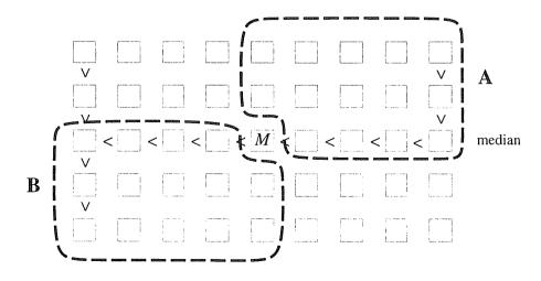
簡単のために比較の回数 T(n) の上界を求めてみよう。 Step 1 では、5 個の数の整列を行
