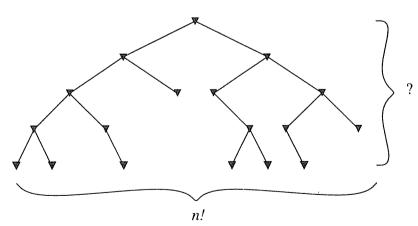
この木構造の点は、アルゴリズムの動いているときの時点を意味し、特に頂上の点は入力が された時点を意味している。アルゴリズムは各時点で2つの数 $x_i$ と $x_j$ (添字はi < jとす る)を比較し、 $x_i < x_j$  と  $x_i > x_j$  の場合に応じて処理を分ける。木構造では、この時点に対応した点から  $x_i < x_j$  ならば左下に進み、 $x_i > x_j$  ならば右下に進むとする。すなわち、木構造で下の点に進むことは、 $x_i$  と  $x_j$  を比較する前に可能性のある答えの集合を、 $x_i < x_j$  であるものと  $x_i > x_j$  であるものに 2 分割し、選択した方に進むことを意味する。下のない点は、答えが見つかったことを意味し、ここでは可能性のある答えはただ一つに定まっていなければならない。また、アルゴリズムの最悪時の時間計算量は、この木構造の深さになっている。
