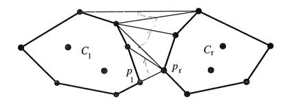
直線  $\overline{v_lv_r}$  が  $C_l$  の上部外接線であるかは、 $v_l$  の  $C_l$  での反時計回りで次の頂点 v' を用いて、点列  $v_r,v_l,v'$  が反時計回りとなるかで判定できる。 $C_r$  についても同様に外接線の判定は行なえる。下部共通外接線についても頂点を逆回りにたどることで求めることができ、共通外接線が 2 本求まった時点で頂点の順序列を更新する。以上の操作は 2 つの凸多角形の頂点の個数に比例する時間があれば十分であるから O(n) 時間で終了する。
