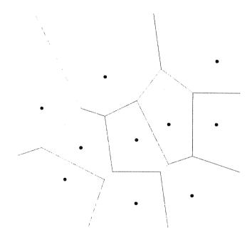
ボロノイ辺上の点は2つの母点から等距離にあるので、2つの母点の垂直2等分線の一部分である。ボロノイ点は3本以上のボロノイ辺の交点なので3つ以上の母点と等距離である。さらに、非退化仮定のもとではボロノイ点はちょうど3つの母点と等距離となり、ちょうど3本のボロノイ辺の交点である。言い換えると、ボロノイ点は直線距離が最短となる3つの母点のつくる三角形の外接円の中心(外心)となる。また、これら3母点以外の母点はこの外接円の外側に存在している。以上のようなボロノイ図の性質を以下で簡単にまとめておく。
