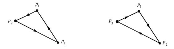
上図の左が反時計回りで、右が時計回りである。反時計回りか時計回りかの判定は、 $p_1$  の位置から  $p_2$  を見たときに  $p_3$  が左側にある場合が反時計回りで、右側にある場合が時計回りである。ベクトル  $a=(x_2-x_1,y_2-y_1)$  に対し、 $b=(-y_2+y_1,x_2-x_1)$  はこれと直行し原点から a 方向を見て b は左側にある。よって、方向ベクトル  $(x_3-x_1,y_3-y_1)$  とベクトル b の内積が正なら  $p_1,p_2,p_3$  は反時計回り、負なら時計回りとなる。すなわち、
