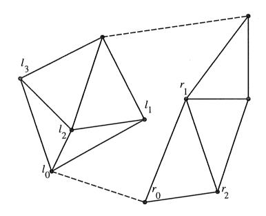
下部共通外接線の $P_1$ の接点を $l_0$ 、 $P_2$ の接点を $r_0$ とし、 $D(P_1)$ で $l_0$ に隣接する頂点を反時計周りに $l_1,l_2,\cdots$ と名前を付け、 $D(P_2)$ で $r_0$ に隣接する頂点を時計周りに $r_1,r_2,\cdots$ と名前を付ける。D(P)には辺 $(l_0,r_0)$ を含む三角形が存在するはずである。その三角形のもう一つの頂点については、以下のような性質が成り立つ。
