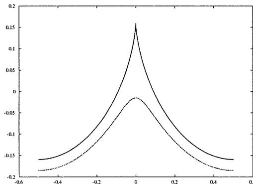
図 5: Gerstner のトロコイド波. 実線の方は  $b = 0$  で, 実はサイクロイドである. 破線の方は  $b = -0.1$  の場合である.
