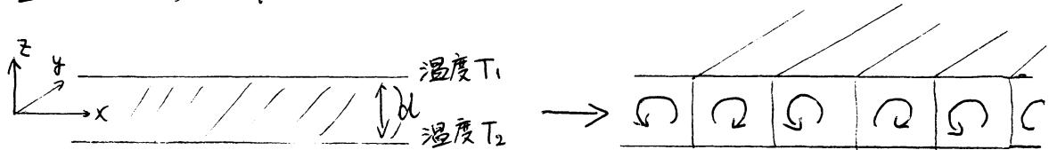
1. 流体層の厚さを  $d$ 、上面の温度を  $T_1$ 、下面の温度を  $T_0$  とします。水平方向を  $x$ ,  $y$ -方向に、垂直方向を  $z$  方向にとると、この対流現象を記述する方程式は、無次元形で書くと、次のようになります。
