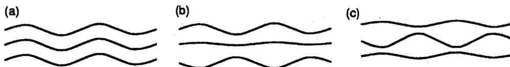
図 4: 2層液体シートでの固有モード (a): 反対称モード, (b): 対称モード, (c): 内部モード
