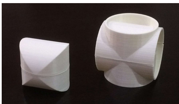
図8 円柱相貫に関する立体モデル教材とプリント教材
