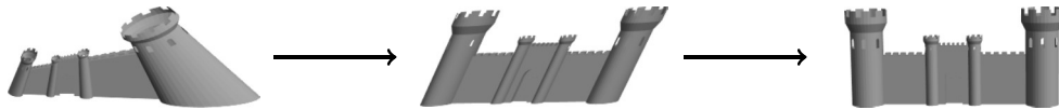
図 3.1 3次元形状の再構成の手続き。左から順に射影再構成、アフィン再構成、計量再構成によって得られる 3次元形状の例である。それぞれ射影変換、アフィン変換、相似変換で動かした 3次元形状のデータを \varphi で平面に射影して描いた。
