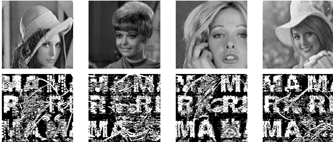
図 23: 複数攻撃 (JPEG 圧縮と切り取り) した透かし入り画像と抽出した透かし
